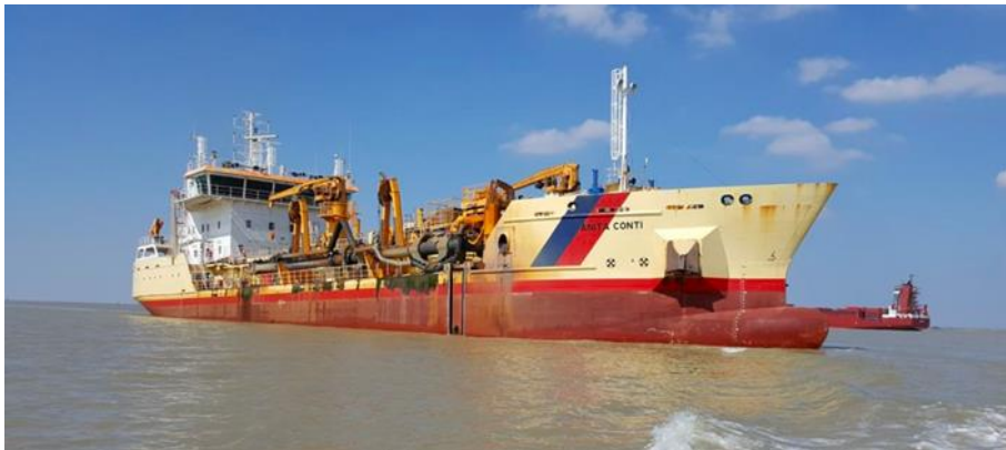
Photographie : Drague par Injection d'Eau (DIE) - Source : GPMB
